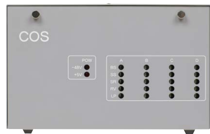
アナログ専用線用インバンドリンガー 従来のアナログ専用線に用いられます。端末側に設置される宅内装置と電話局側に設置される局側装置があります。
