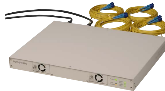
光回線自動切替装置 (APS) 光回線 (155Mbps) を常時監視して、何らかの異常を検出すると即座に予備回線に切り替える装置です。光通信網の幹線系に設置されて通信の高度な信頼性を保証します。
