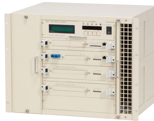
10Gbit Ethernet 伝送装置 多数の電気信号で並列伝送されるデータを、1本の10ギガビットの高速な光信号に変換して伝送します。電気信号では数mしか伝送できないところを、信頼性の高い数十kmの伝送が実現できます。
